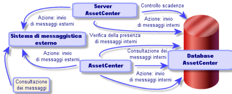
Figura 15.1. Sistema di messaggistica - funzionamento generale
