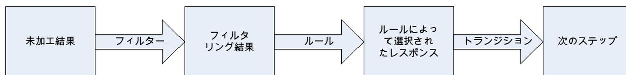
図 4 - オペレーションの未加工結果から次のステップが決まる仕組み
