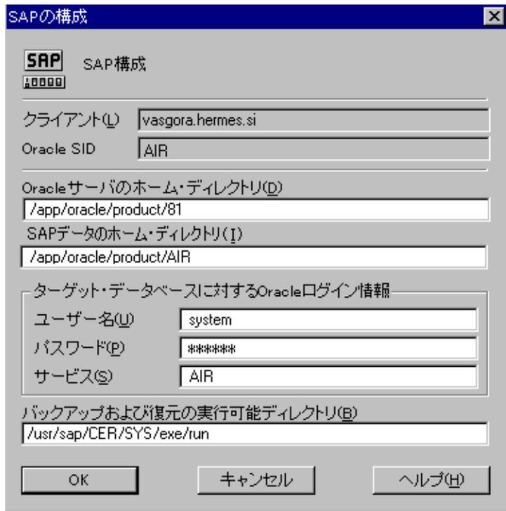
図 33 UNIXシステム上のSAP R/3データベースの構成(オペレーティングシステム認証モード)
