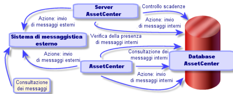
Figura 15.1. Sistema di messaggistica - funzionamento generale
