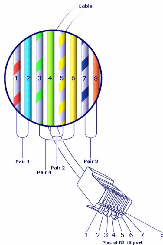
Bei dem abgebildeten Steckverbinder **RJ-45** ist jeder Stift einem Draht mit einer bestimmten Farbe zugeordnet, wobei jeder Draht eine spezifische Funktion erfüllt:
