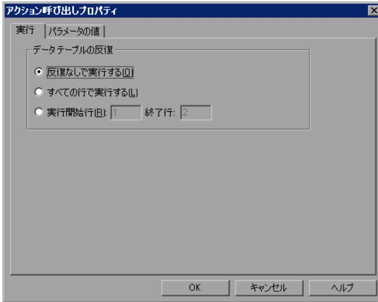
実行タブで **[すべての行で実行する]** を選択します。メッセージ・ボックスが開いたら、内容を確認し、**[OK]** をクリックして閉じます。**[OK]** をクリックし **[アクション呼び出しプロパティ]** ダイアログ・ボックスを閉じます。
