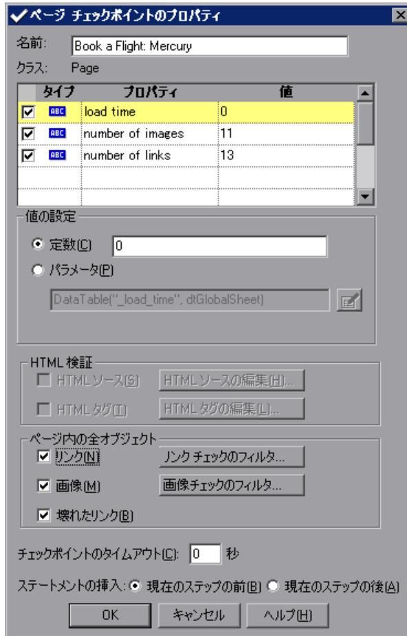
QuickTest テストを実行すると、ダイアログ・ボックス上部の表示枠に表示されているように、Web ページのリンク数と画像数およびロード時間が検査されます。
