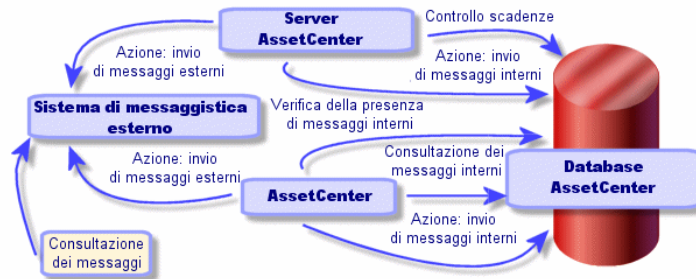
Figura 8.1. Sistema di messaggistica - funzionamento generale
