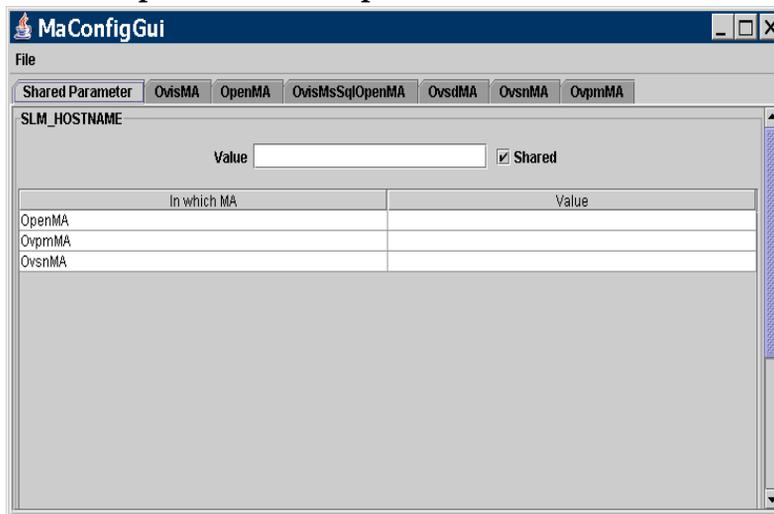
El panel de parámetros compartidos se utiliza para actualizar varios adaptadores de indicador de forma simultánea. Se introduce un único valor de parámetro y se comparte entre todos los adaptadores de indicador que se enumeran en la tabla haciendo clic en la casilla de verificación Compartido para que esté *activada* para el parámetro.
