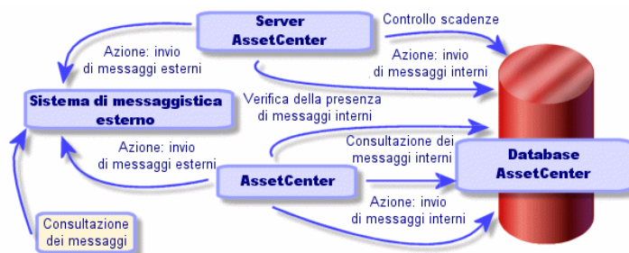
Figura 8.1. Sistema di messaggistica - funzionamento generale
