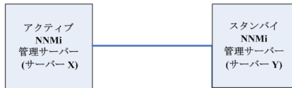
図 4 アプリケーションフェイルオーバーでの CA 証明書の使用法
