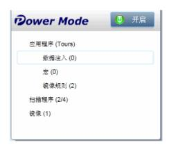
要使用超级模式,需要为测试定义**应用程序**。这是将测试的应用程序。通过为测试定义应用程序,Sprinter 能够识别应用程序中的对象和屏幕以使用上面描述的超级模式功能。
