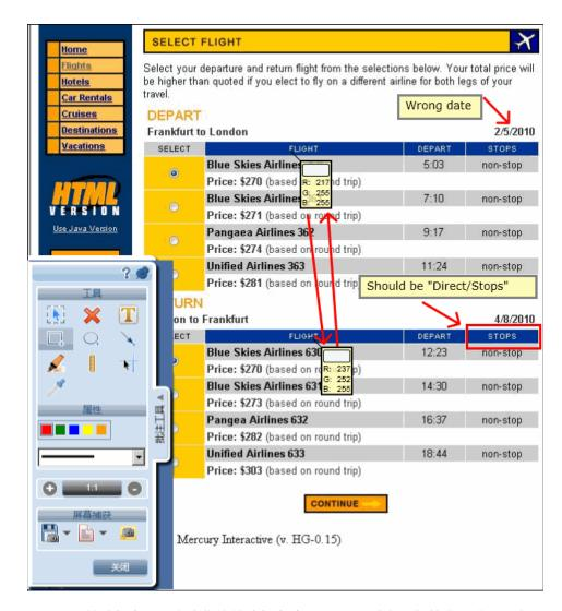
Sprinter 缺陷提交工具允许您将缺陷提交给 ALM、通过电子邮件发送或打印应 用程序屏幕的带批注的屏幕捕获。
