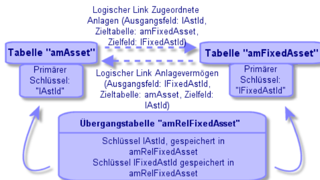
Abbildung 2.2. Verknüpfungen zwischen der Anlagentabelle und der Vermögenstabelle
