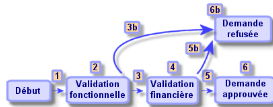
Figure 9.3. Workflow - modèle de validation des demandes
