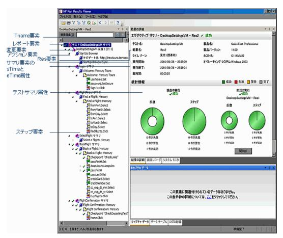
XSL で提供されているツールを使用すると、どの実行結果情報をどのような形式でどこに表示、印刷、エクスポートするかを指定できます。また、.xsl ファイルが参照する .css ファイルを変更することによって、レポートの外観(フォント、色など)を変えることもできます。
