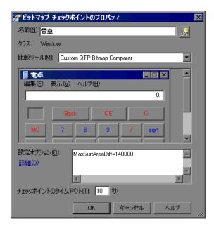
[ビットマップ チェックポイントのプロパティ] ダイアログ・ボックスの [**設定オプション**] ボックスでは、**GetDefaultConfigurationString** メソッドによって返される標準設定文字列、MaxSurfAreaDiff=140000 を表示できます。
