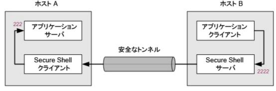
アプリケーションサーバと Secure Shell クライアントの両方はホスト A で実行されます。Secure Shell サーバとアプリケーションクライアントの両方はホスト B で実行されます。ホスト B のポート 2222 へ送信されたすべてのデータは ホスト A のポート 222 へ転送されます。この配置では、転送中のすべてのデータが安全に暗号化されます。これは、以下のコマンドによって構成します。
