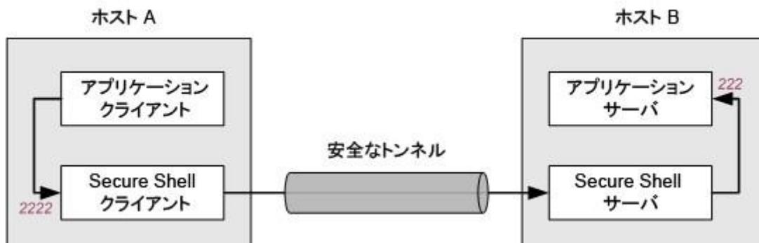
上記の構成では、アプリケーションクライアントと Secure Shell クライアントの両方がホスト A で実行されます。Secure Shell サーバとアプリケーションサーバの両方はホスト B で実行されます。ホスト A のポート 2222 へ送信されたすべてのデータはホスト B のポート 222 へ転送されます。この配置では、転送中のすべてのデータが安全に暗号化されます。これは、以下のコマンド (localhost はホスト B のループバックアドレスを識別します) によって構成します。
