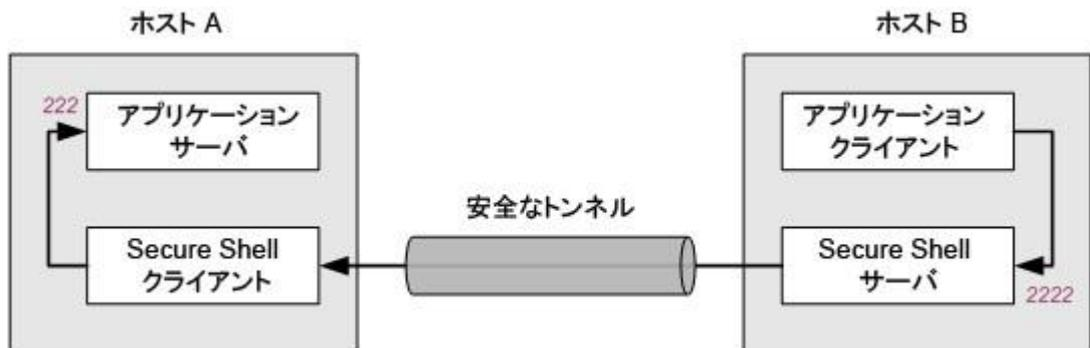
HostAでは、アプリケーションサーバと SecureShellクライアントが動作しています。HostB では、Secure Shell サーバとアプリケーションクライアントが動作しています。HostB のポート 2222 に送信されるすべてのデータが、HostA のポート 222 に転送されます。この配置では、通過中のすべてのデータが安全に暗号化されます。これを構成するコマンドは次のとおりです。
