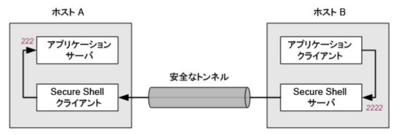
HostA では、アプリケーションサーバと Secure Shell クライアントが動作しています。HostB では、Secure Shell サーバとアプリケーションクライアントが動作しています。HostB のポート 2222 に送信されるすべてのデータが、HostA のポート 222 に転送されます。この配置では、通過中のすべてのデータが安全に暗号化されます。これを構成するコマンドは次のとおりです。
