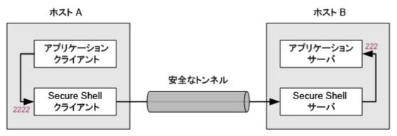
上記の構成では、アプリケーションクライアントと Secure Shell クライアントの両方がホスト A で実行されます。Secure Shell サーバとアプリケーションサーバの両方はホスト B で実行されます。ホスト A のポート 2222 へ送信されたすべてのデータはホスト B のポート 222 へ転送されます。この配置では、転送中のすべてのデータが安全に暗号化されます。これは、以下のコマンド(localhost はホスト B のループバックアドレスを識別します)によって構成します。
