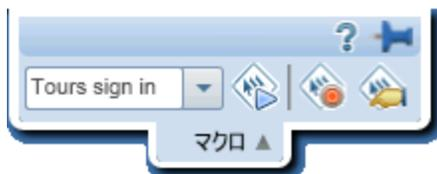
記録ボタンをクリックし、マクロに必要な操作の実行を開始します。一連の操作を実行し終わったら、**【記録の停止】** ボタンをクリックしてマクロを保存します。
