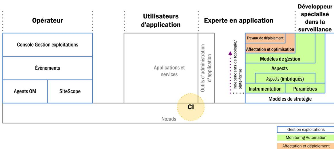
La base de la pile représente les éléments de configuration à surveiller. Les éléments de configuration peuvent être des éléments réseau tels que des ordinateurs, des applications ou des ensembles d'applications offrant un service. L'accès aux éléments de configuration s'effectue de l'une des manières suivantes :
