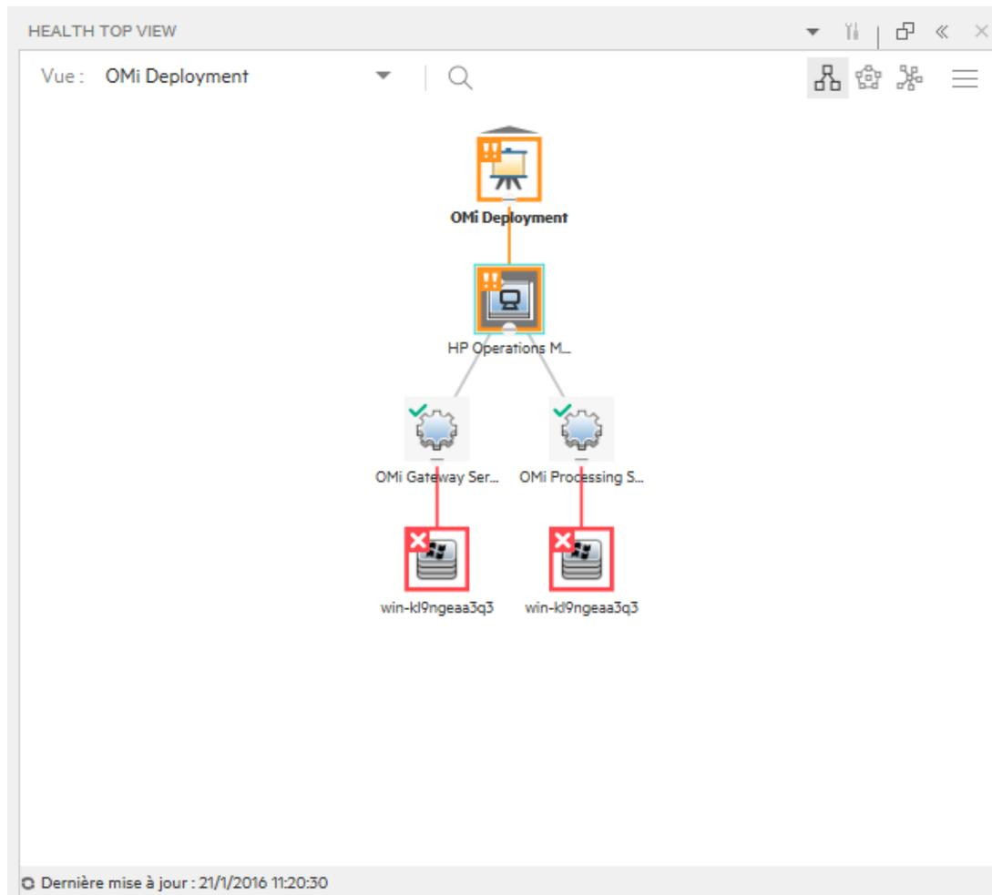
La vue supérieure Intégrité permet à un opérateur de voir l'intégrité de n'importe quel élément de configuration du diagramme de topologie. L'examen des éléments de configuration situés en amont et en aval peut fournir d'autres indices susceptibles de faciliter l'identification du problème.
