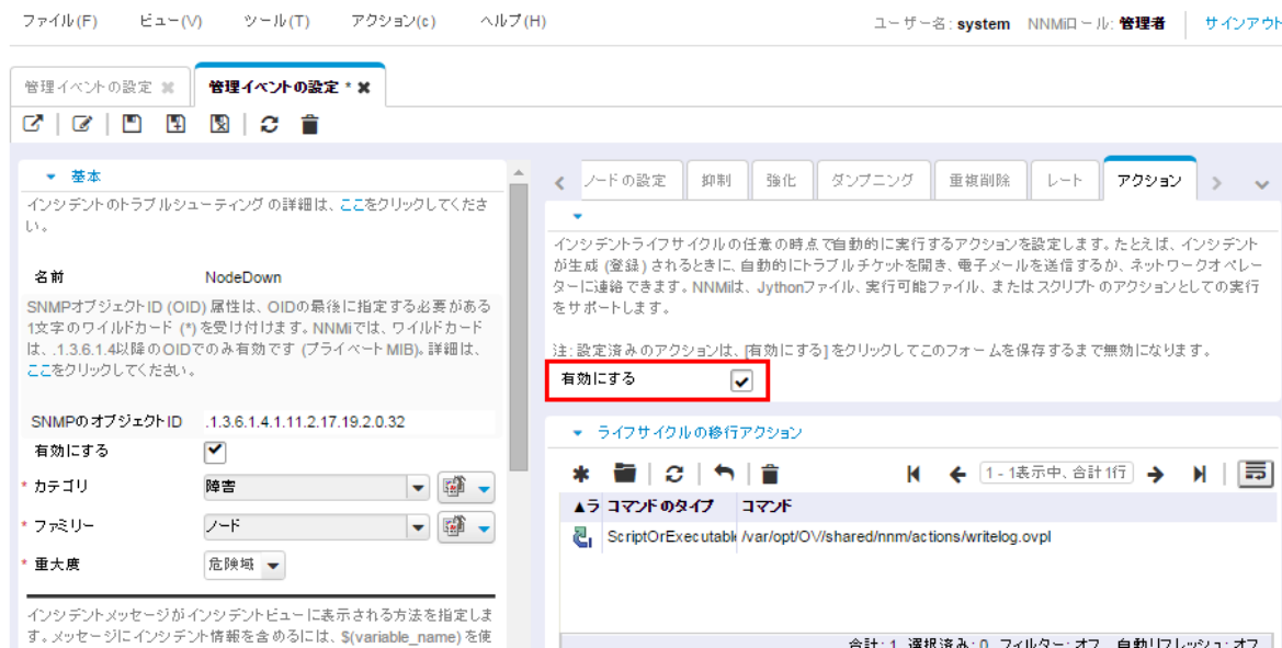
図 59: 管理イベントの設定:[アクション]タブ:アクションを有効化
