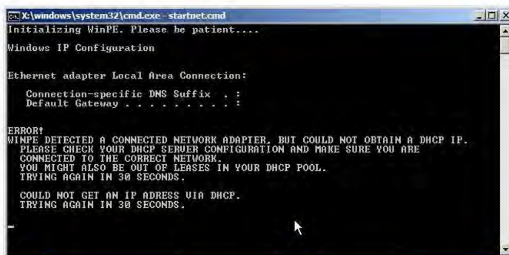
図19: DHCPサーバーが見つからない場合のWinPEコンソール表示
