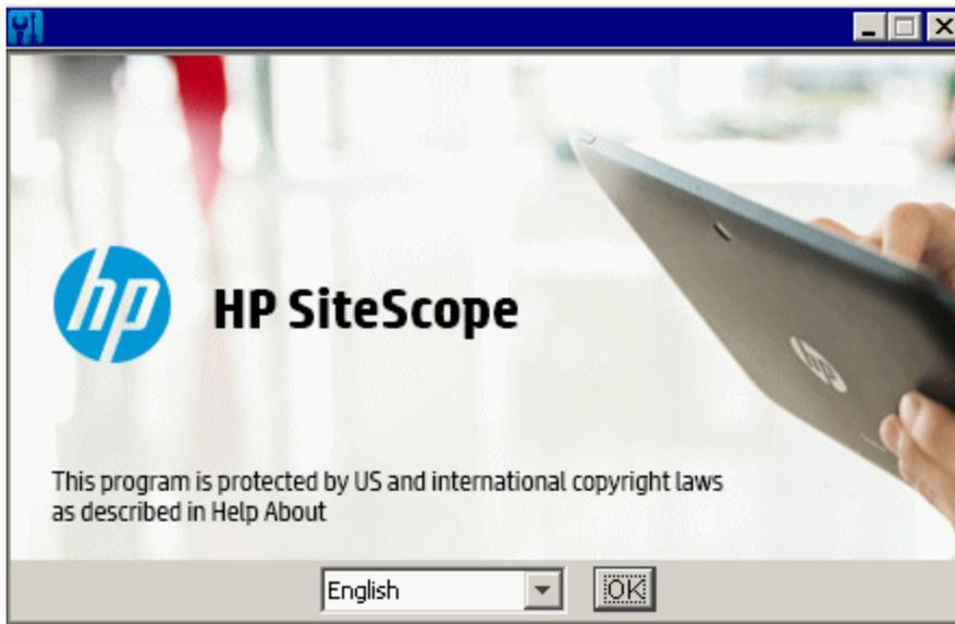
Wählen Sie aus der Liste der Sprachen eine Sprache für die SiteScope-Installation. Abhängig von dem Gebietsschema des Betriebssystems zeigt das Installationsprogramm verschiedene Sprachgruppen an. Eine Liste der für die SiteScope-Benutzeroberfläche verfügbaren Sprachen finden Sie unter "Internationalisierung in SiteScope" im Handbuch Verwenden von SiteScope.
