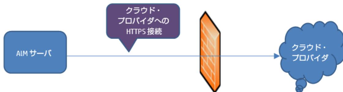
ALM サーバが通信を開始し、企業ファイアウォールを経由してクラウド・プロバイダに通信します。ポートが開くのは、発信要求のみです。
