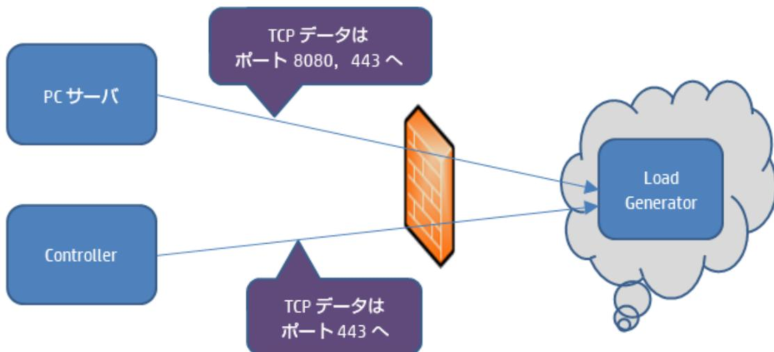
Performance Center サーバと Controller が通信を開始し、ファイアウォールを経由してクラウドベースの Load Generator に接続します。データはポート経由で転送され、TCP(Transmission Control Protocol) が使用されます。ポートは発信要求に対して開かれます。ポートは再設定が可能です。
