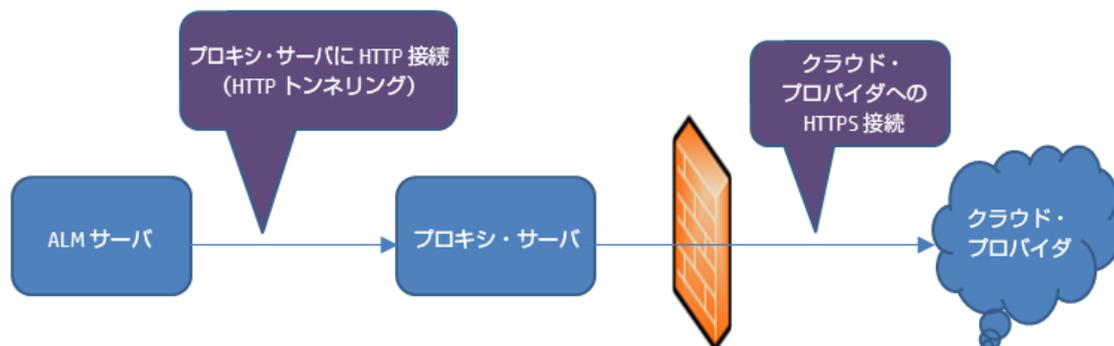
ALM サーバが、HTTP トンネリングを使用して、定義されたプロキシ・サーバとの通信を開始します。プロキシ・サーバは企業ファイアウォールを経由して、発信要求をクラウド・プロバイダに転送します。
