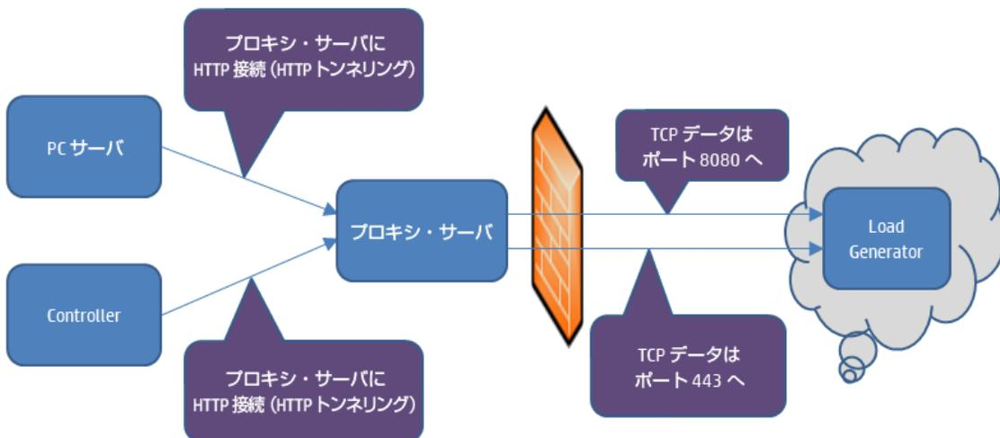
Performance Center サーバと Controller が通信を開始し、定義したプロキシ・サーバに接続します。Performance Center サーバと Controller からプロキシ・サーバへの通信には HTTP トンネルが使用されます。プロキシ・サーバはファイアウォールを経由して、データを TCP ポートからクラウドベース Load Generator に転送します。
