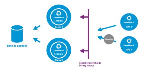
Remarquez dans cette topologie la présence d'un RAS autonome (RAS 3, contenant le travailleur 3). RAS 3 est un RAS identique à RAS 1 et RAS 2. Il est simplement installé en tant que processus autonome.
