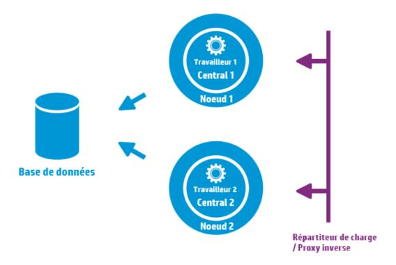
Au contraire des versions antérieures, il n'est pas nécessaire d'utiliser un logiciel de gestion de cluster et il n'est pas non plus nécessaire d'avoir un système de fichiers partagé. La fonction du répartiteur de charge/du proxy inverse et d'exposer une seule URL aux clients du système ; toutefois, le répartiteur de charge/le proxy inverse est facultatif et n'est pas indispensable au cluster. Il est également possible d'exposer une seule URL via la répartition de charge DNS.
