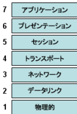
図 11 OSI7階層モデル
