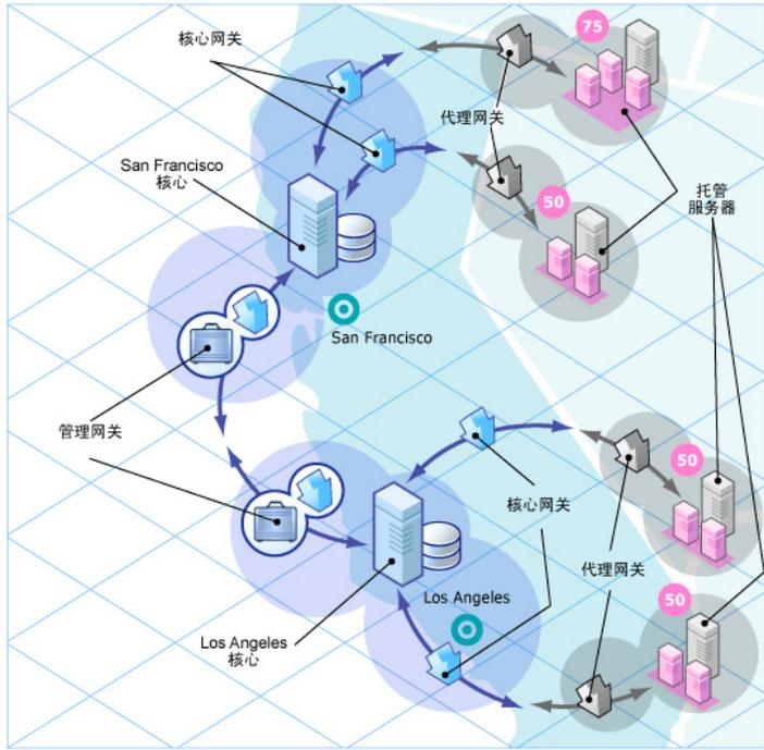
图 9 显示了包含四个核心的多主控网状网络。此网状网络拓扑被称为星形结构，San Francisco 核心位于此网状网络的中心。SA 安装程序配置星形拓扑中的多主控网状网络，并默认使用备份网关路由。
