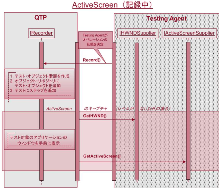
次の図は、実行結果レポート用にステップ画面キャプチャを保存するときに、QuickTest が呼び出すメソッドの一般的なシーケンスを示します。これは、Testing Agent が実装する必要があるメソッドの目的を示しています。
