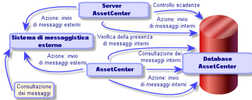
Figura 13.1. Sistema di messaggistica - funzionamento generale
