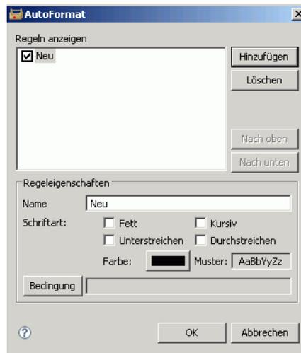
Sie sollten die Regeln und Bedingungen für automatisches Format verringern (**Zusammenfassung anzeigen** → **AutoFormat** → **AutoFormat**), um die Leistung zu verbessern.
