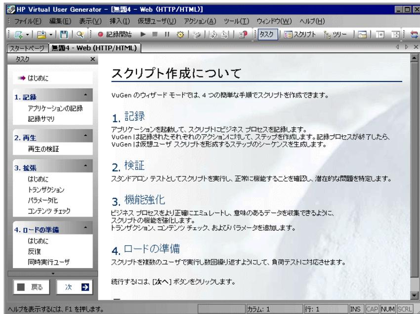
VuGen のウィザードでは、段階的にスクリプトを作成し、そのスクリプトをテスト環境に適合させることができます。[タスク] 表示枠には、スクリプト作成プロセスの各手順またはタスクが表示されます。各手順の進行に従い、VuGen によってウィンドウのメイン・エリアに詳細な指示およびガイドラインが表示されます。
