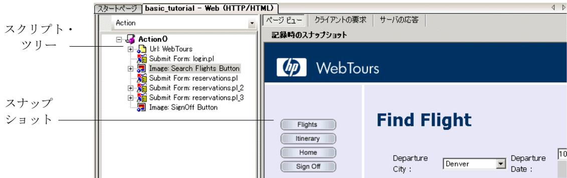
ツリー・ビューには、ユーザのアクションがスクリプト・ステップとして表示されます。大部分のステップには、対応する記録のスナップショットが添付されています。
