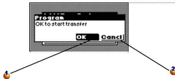
1: Convalidare con **OK** tramite il tasto [SPACE] del lettore per lanciare il trasferimento.
